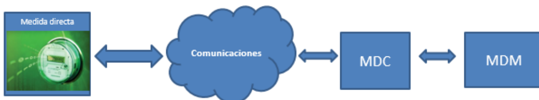
Figura 2. Modelo de bloques del sistema.
